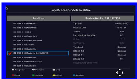
**Tipo di LNB:** Indica il tipo di LNB. Qui è possibile selezionare la frequenza intermedia dell'LNB. La frequenza standard è 09750/10600.
