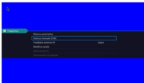
La funzione «Recherche automatique/ricerca automatica» permette di scorrere tutta la banda delle frequenze e tutte le stazioni memorizzate. Con la ricerca manuale si inserisce una determinata frequenza e i programmi vengono memorizzati.
