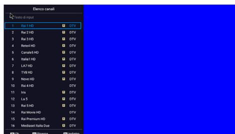
Se un programma è già stato selezionato e si desidera passare ora a un altro programma, utilizzare per esempio i tasti CH+/CH- dell'apparecchio o CH+/CH- del telecomando.
